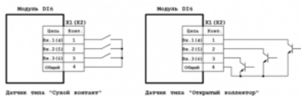
Схема подключения субмодуля дискретных входов DI6
